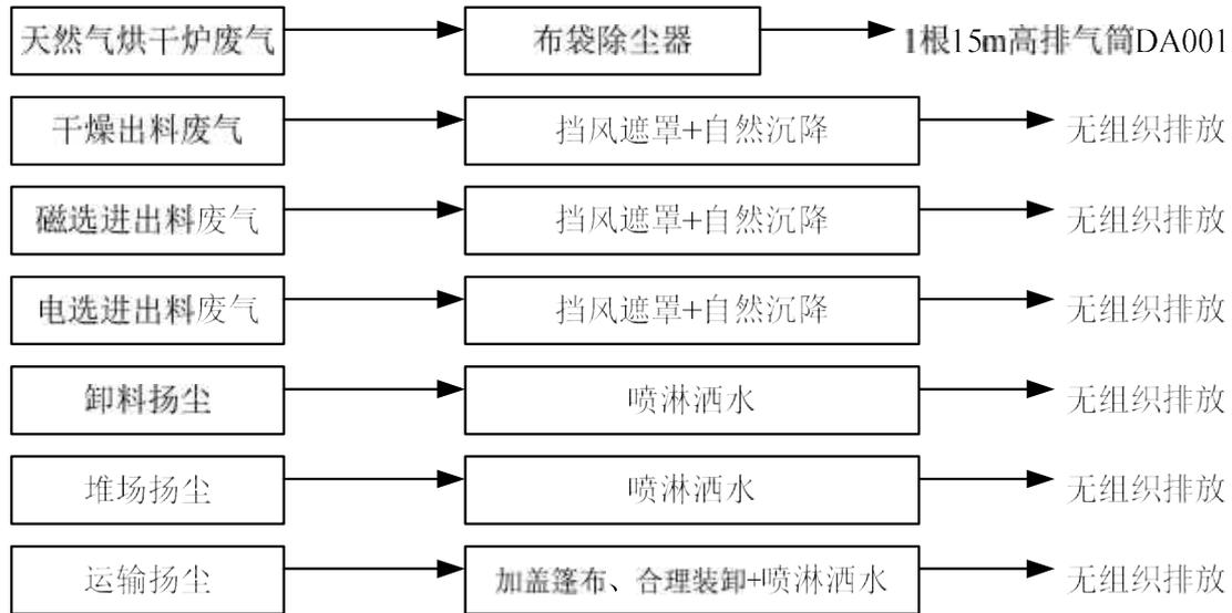
图 6.1-2 项目废气处理工艺流程图
