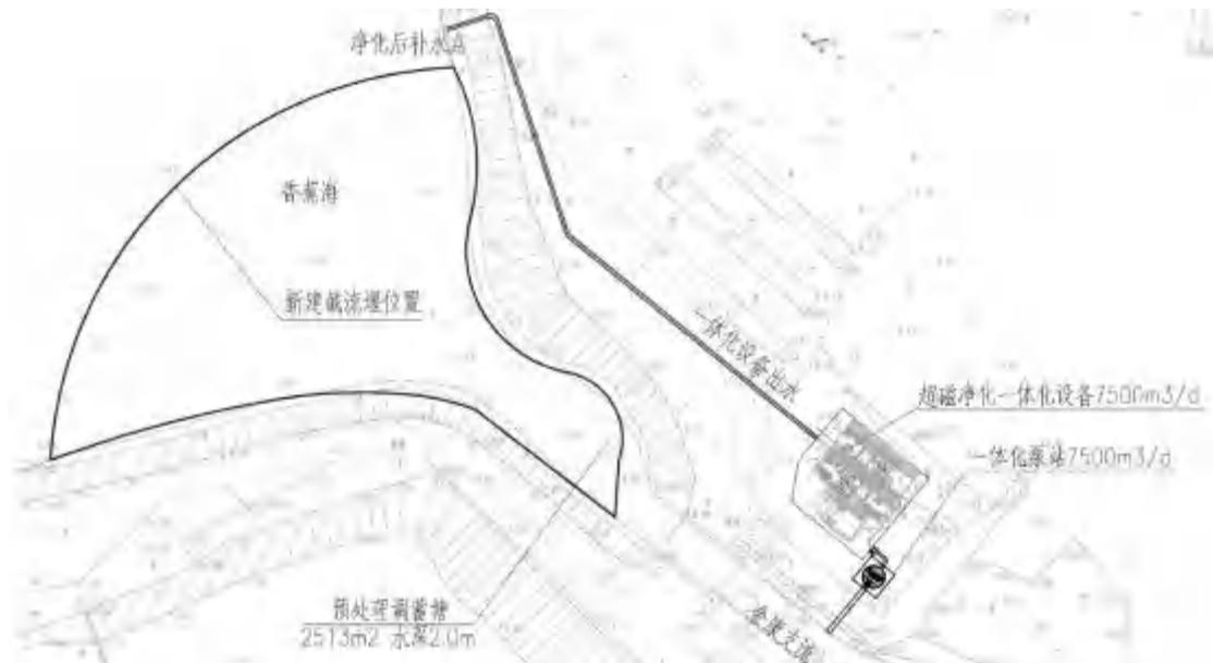
图 3-23 溢流污染控制布置总平面图
