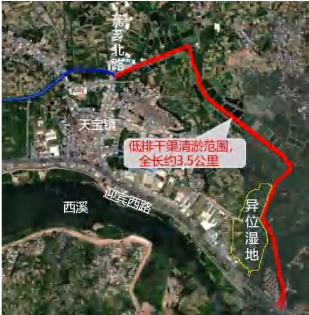
图 3-10 低排干渠清淤平面布置图
