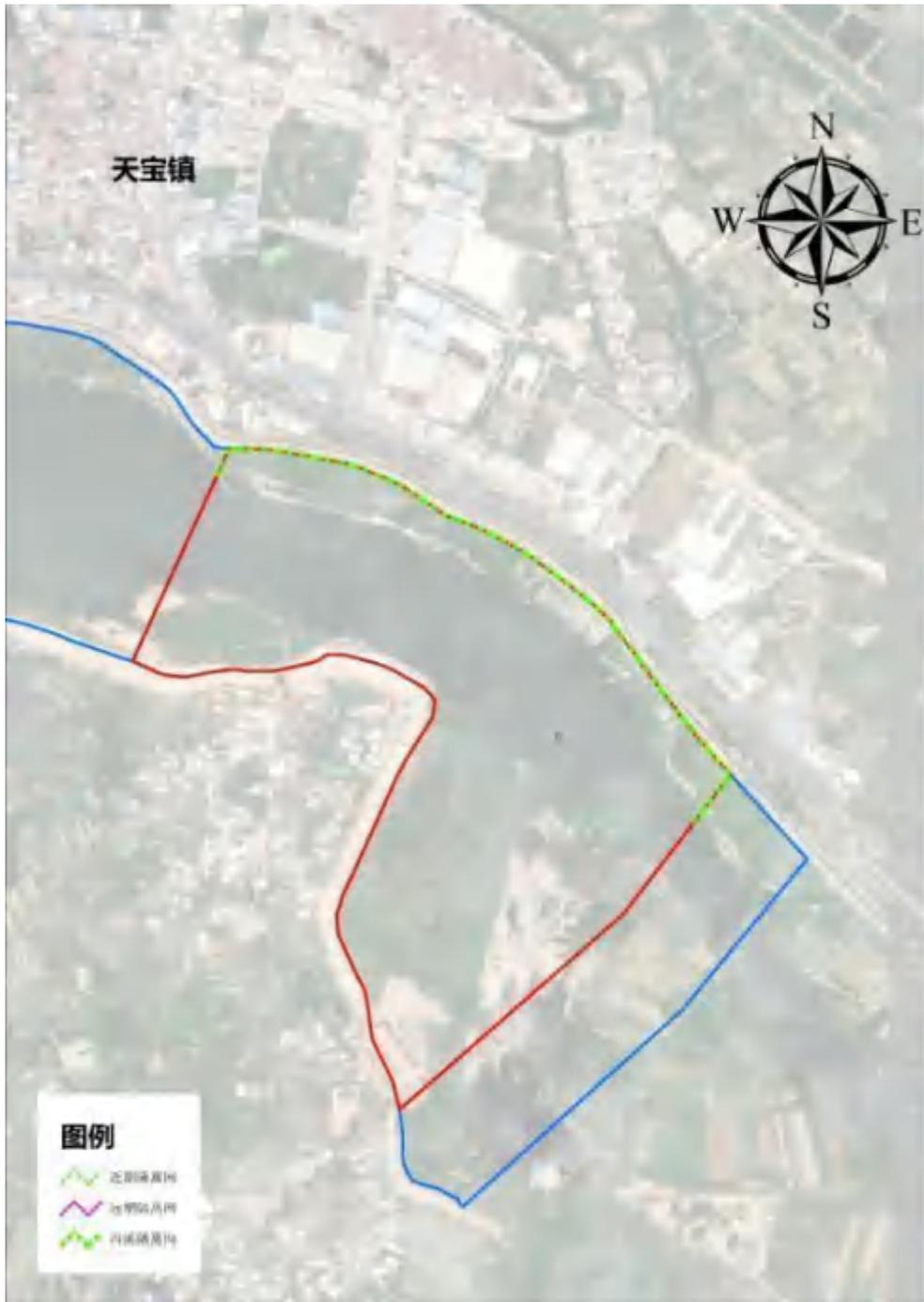
图 3-29 金峰水厂饮用水源地一级保护区隔离网建设方案
