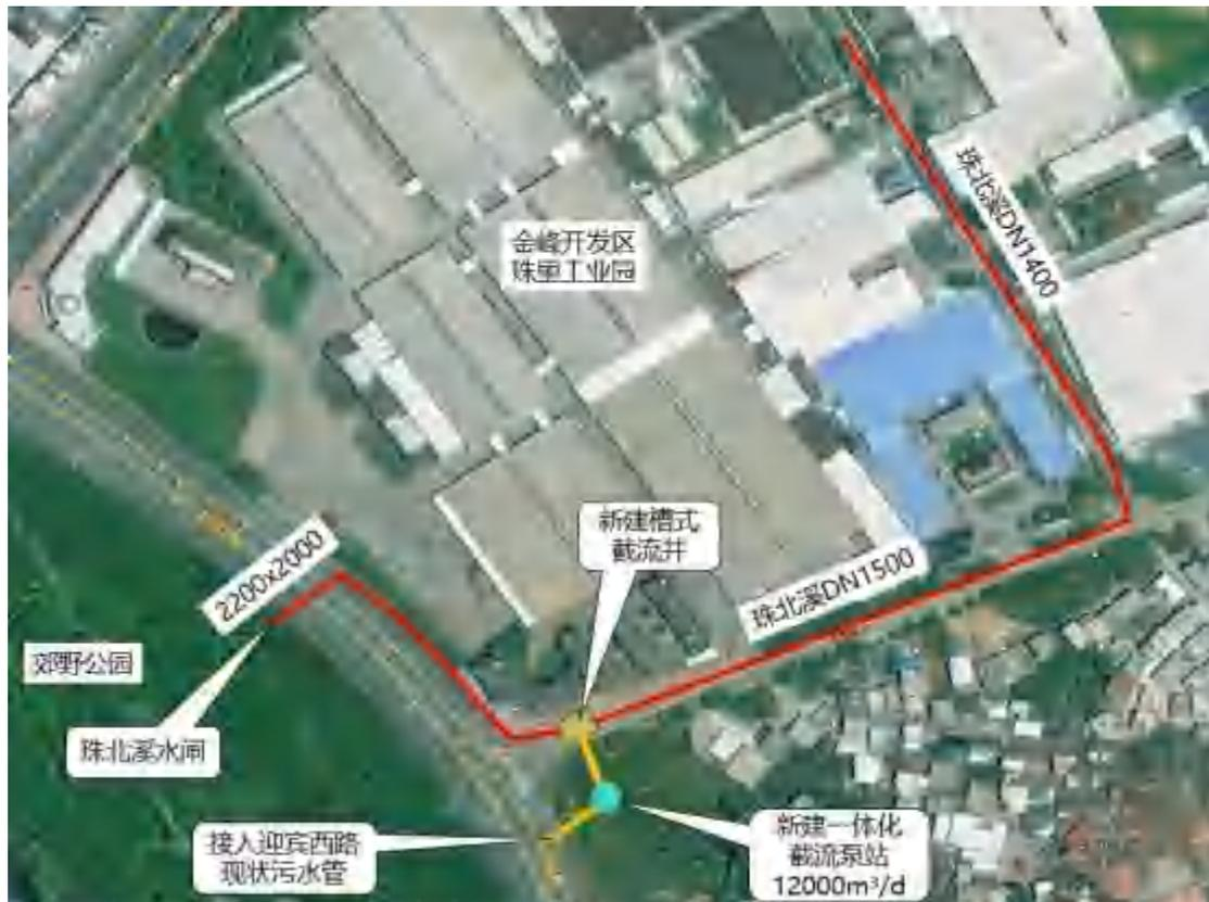
图 3-18 珠北溪截污工程布置平面图
