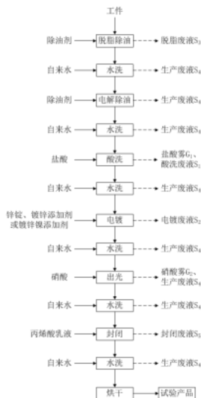
图 2.6-1 生产工艺流程及产污环节图
